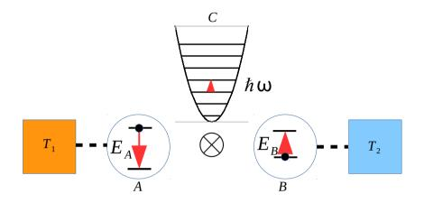
$$\mathcal{H}_S = \frac{E_A}{2}\sigma_A^z + \frac{E_B}{2}\sigma_B^z + \hbar\omega a^{\dagger}a + \lambda\left(\sigma_A^-\sigma_B^+a^{\dagger} + \sigma_A^+\sigma_B^-a\right)$$
